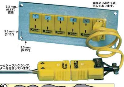
CASS-316U-12プローブは無料の組み合わせコネクターとケーブルクランプ、 EXPP-K-24-25ワイヤー、およびSMPW-K-Mコネクターを付属しています。
