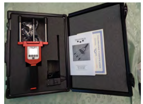
テンションメータ、校正証明書、電源アダプタと取扱説明書が収容されたキャリングケース
