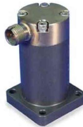
型式 4-123 振動変換器は、とりわけタービン・アプリケーションに最適です。この変換器は 260°C 迄動作し、交差軸加速度に対して低感度です。また、この変換器を水平及び垂直間のいかなる平面にも取付けることができます。感度軸は、変換器のケース底面に対し垂直です。自己励起、高出力レベル、低出力インピーダンスのため特別なローノイズケーブルやチャージ増幅器が不要で計測システムが簡単になり信頼性が高まります。
