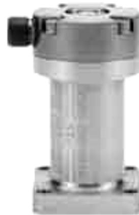
型式 4-125 振動変換器は、とりわけタービン・アプリケーション用に製作されています。この変換器は 371°C迄動作し、タービン・ケースの様な高温部でも、使用することができます。交差軸加速度に対して低感度です。また、この変換器を水平及び垂直間のいかなる平面にも取付けることができます。感度軸は、変換器のケース底面に対し垂直です。自己励起、高出力レベル、低出力インピーダンスのため特別なローノイズケーブルやチャージ増幅器が不要のため計測システムが簡単になり信頼性が高まります。頑丈な構造と設計の明快さにより、高信頼性と長寿命を保証しています。
