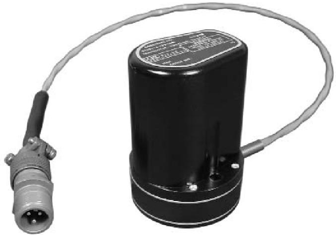
これらの変換器の出力は振動速度に比例し、回転機械の異常監視の測定に最適な場合が多くあります。また、低インピーダンス、高出カレベルで、特別な増幅器を使用せずに交流メータやレコーダを駆動することができ計測システムを簡単にすることが出来ます。
