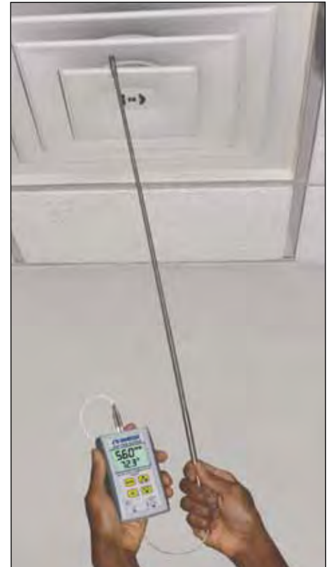
空調ダクトからの空気流量を測定
