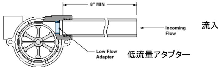
ローター流量センサーはNPT適合ネジを経てパイプに接続する場合、リークが無い接続を確保するために適当なネジ・封止剤の使用が必要です。テフロン・テープの二重巻きが封止のために推奨されます。150ミクロン・フィルターが推せんされます。しかし、外部粒子がローター流量センサーに入ったとき、本体からレンズを取り外して簡単に清掃できます。レンズの7/16"六角センターリブを45度反時計方向に回転し、それを引き抜き、レンズを取り外すことができます。レンズの再取り付けのためには、逆の方法をして下さい。オーリングは取り付けの前に潤滑剤を塗って下さい。ローターセンサを清掃する前にシステムから圧力を解放しておく必要があります。
